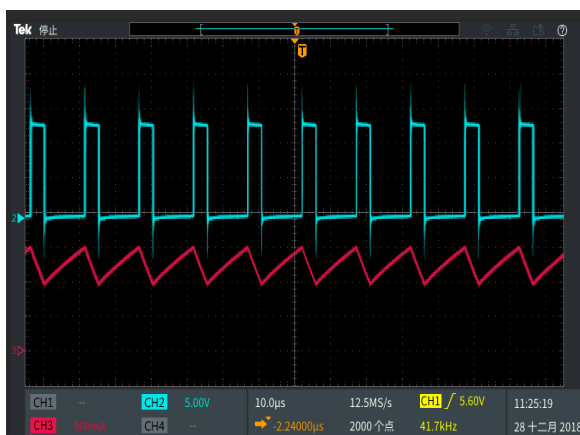
SW 脚与电感电流工作波形
