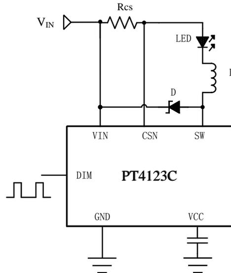
通过PWM调光，LED的输出电流可以从0%到100%变化。LED的亮度是由PWM信号的占空比决定的。例如PWM信号25%占空比，LED的平均电流为(0.2/Rcs)的25%。建议设置PWM调光频率在100Hz以上，以避免人的眼睛可以看到LED的闪烁。PWM调光比模拟调光的优势在于不改变LED的色度。PT4123C调光频率最高可超过20kHz。
