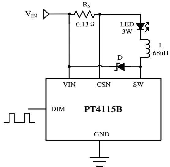
通过 PWM 调光, LED 的输出电流可以从 0%到 100%变化。LED 的亮度是由 PWM 信号的占空比决定的。例如 PWM 信号 25%占空比, LED 的平均电流为 $(0.1/R_s)$ 的 25%。建议设置 PWM 调光频率在 100Hz 以上, 以避免人的眼睛可以看到 LED 的闪烁。PWM 调光比模拟调光的优势在于不改变 LED 的色度。PT4115B 调光频率最高可超过 20kHz。
