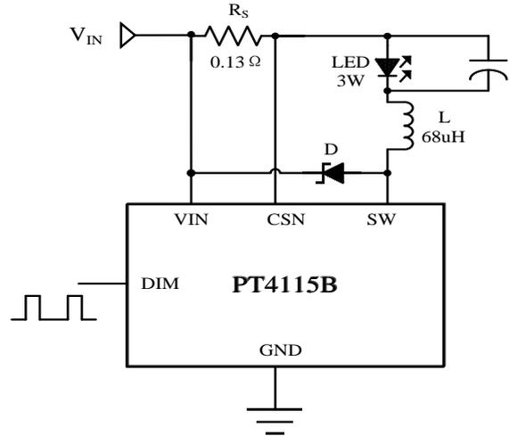
1uF 的电容可以使输出纹波减少大约 1/3。适当的增大输出电容可以抑制更多的纹波。需要注意的是输出电容不会影响系统的工作频率和效率，但是会影响系统启动延时以及调光频率。
